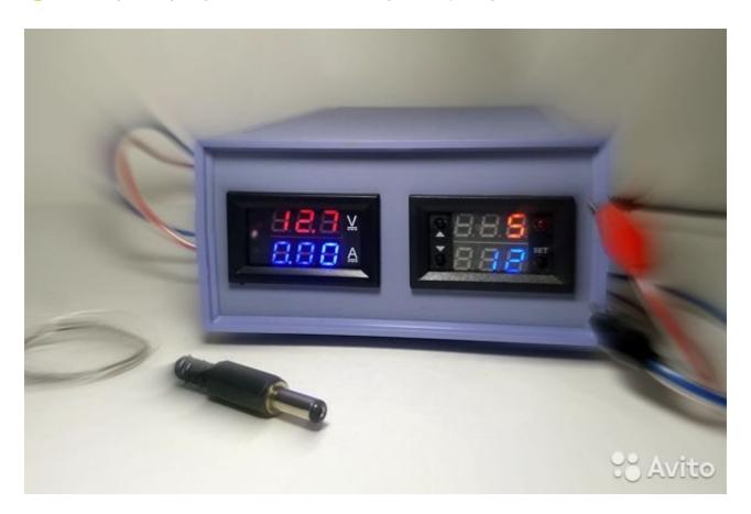
Электростатическая коптильня блок управления с цикличным таймером. Для коптильни холодного и горячего копчения объемом коптильной камеры , коптильного шкафа до 1куба
